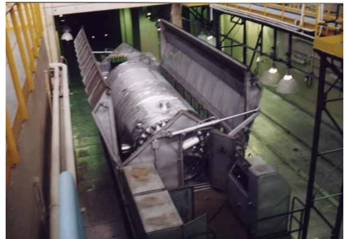
9 Выгрузка ОЯТ из спецвагона. (Фото: «Экозащита!»)
